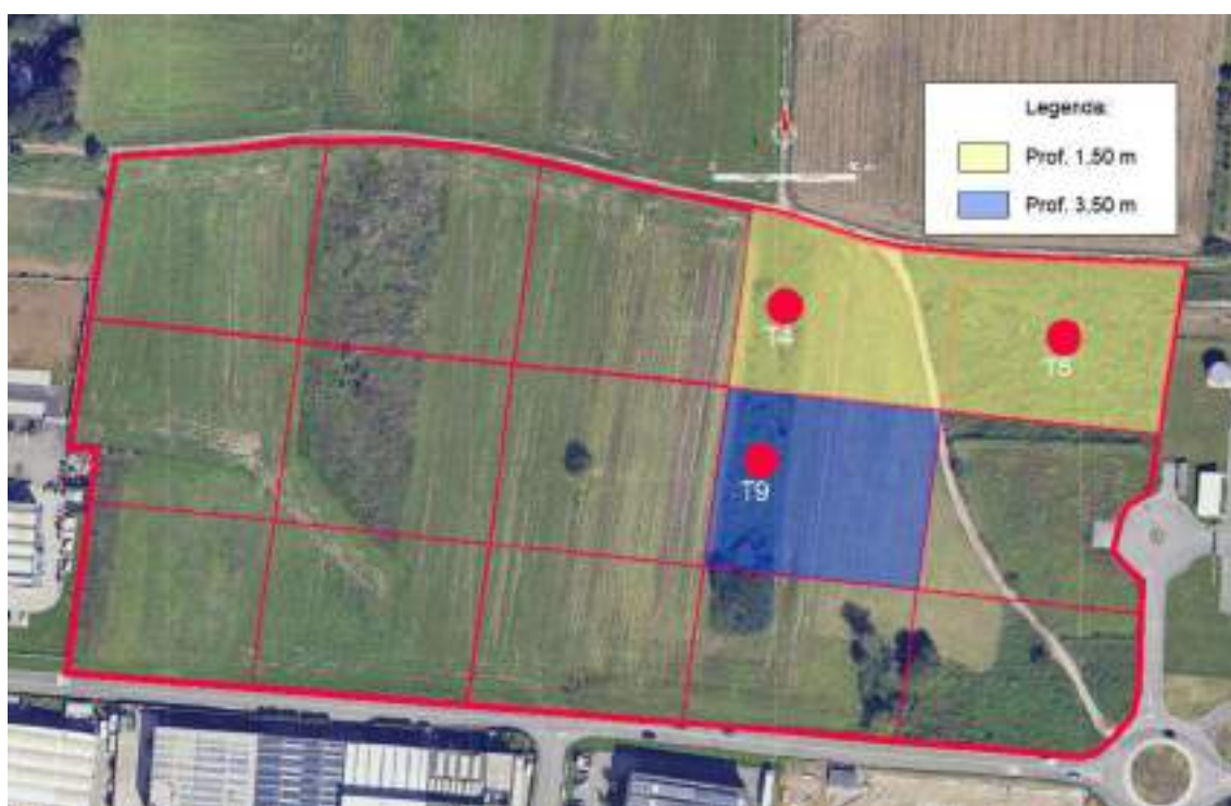
Fig. 9.1 – Aree e profondità di scavo
