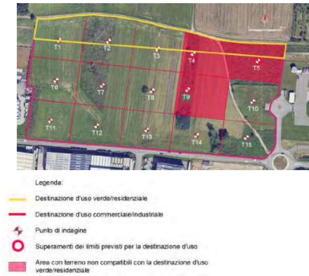
Fig. 7.1 - Destinazioni d'uso dell'area e superamenti riscontrati
