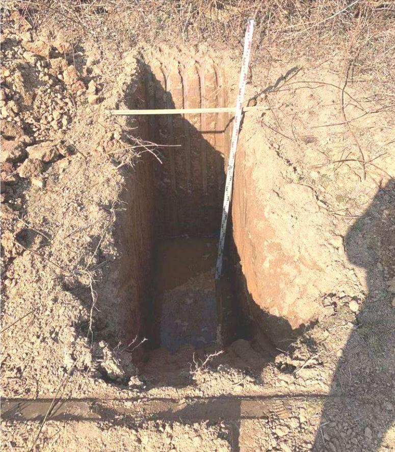
Esecuzione prova di permeabilità
