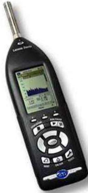
Lo strumento è stato calibrato mediante la sorgente di riferimento Larson Davis CAL 200 conforme alle prescrizioni definite dalla norma IEC 942/1988 per la strumentazione di classe 1.
