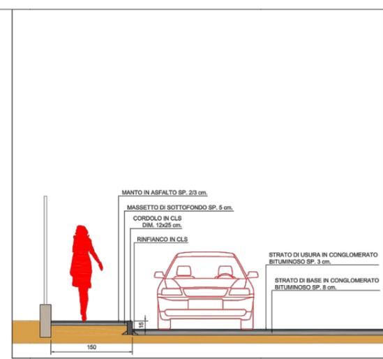
SEZIONE TIPOLOGICA MARCIAPIEDE - SUPERFICIE STRADALE - scala 1:50
