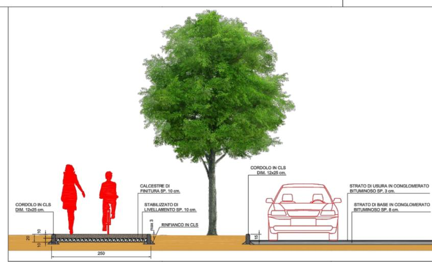
SEZIONE TIPOLOGICA PISTA CICLABILE - SUPERFICIE STRADALE - scala 1:50
